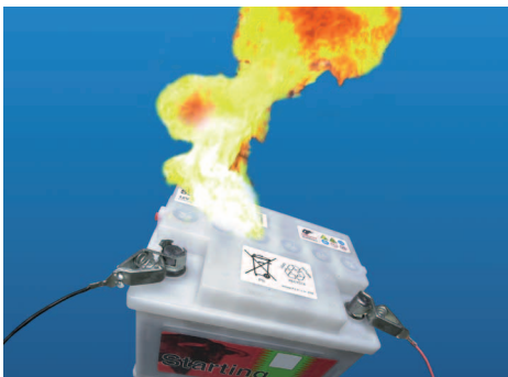
Abbildung 17: Explosion einer Autobatterie
