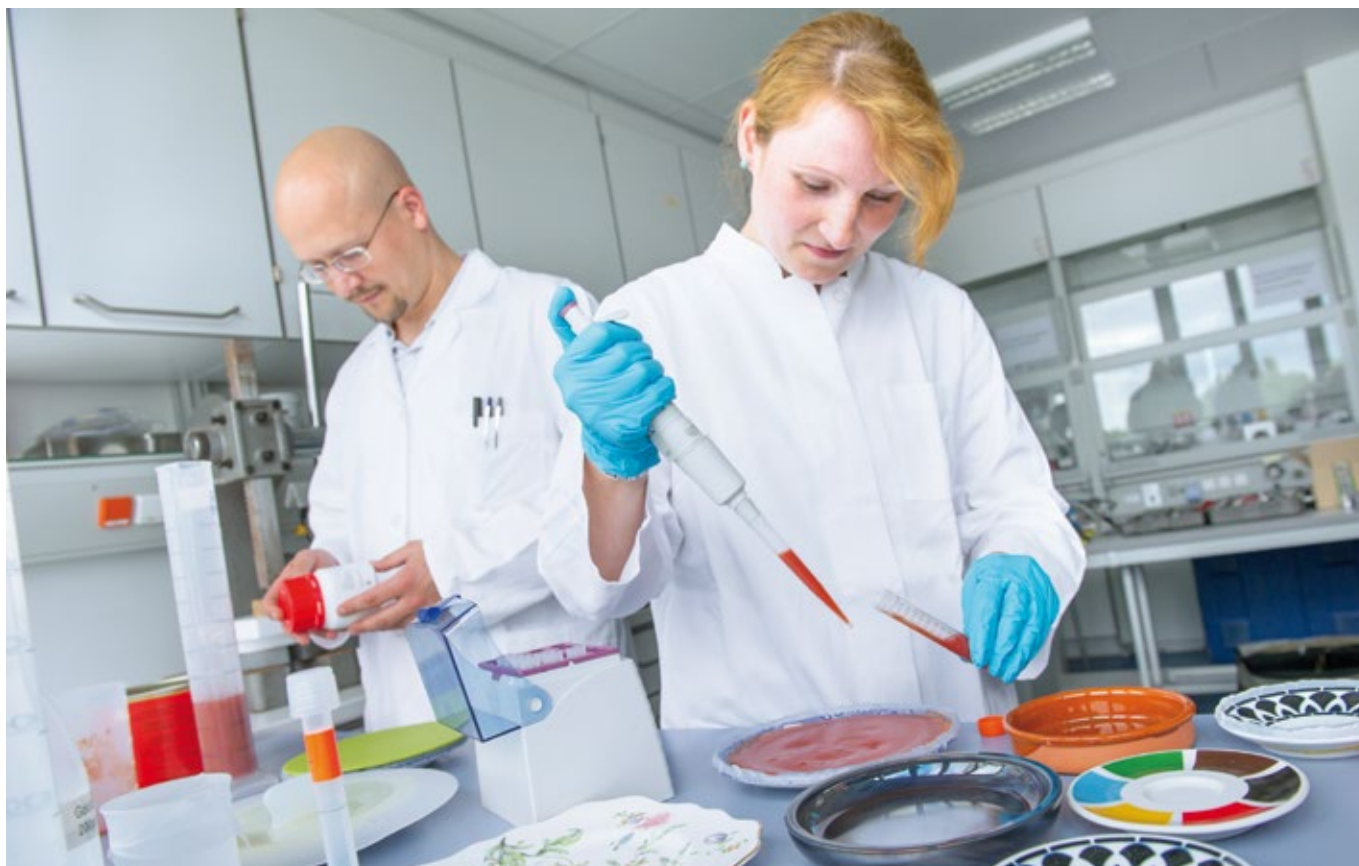
Mitarbeiter eines am BfR angesiedelten Nationalen Referenzlabors erarbeiten und validieren Analysenverfahren für die Prüfung der Freisetzung von Schwermetallen aus Keramik- und Glaswaren in Lebensmittelsimulanzien.
